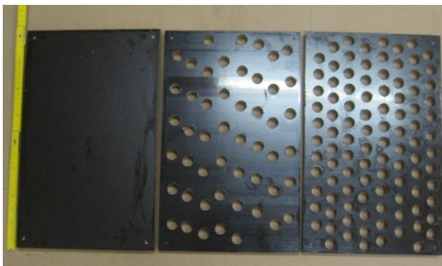
Abbildung 7: Die im Versuch für Gruppe A verwendete Puzzlebox in ihren Einzelteilen. Die Platten wurden von rechts nach links übereinander gelegt und miteinander verschraubt.
